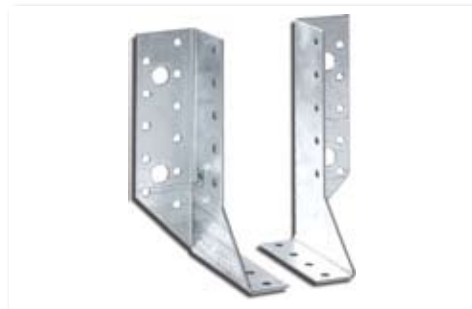
Sabot mixte 2 parties, épaisseur 2,0 mm En acier galvanisé Trous à scellement Ø 11 mm/5 mm
