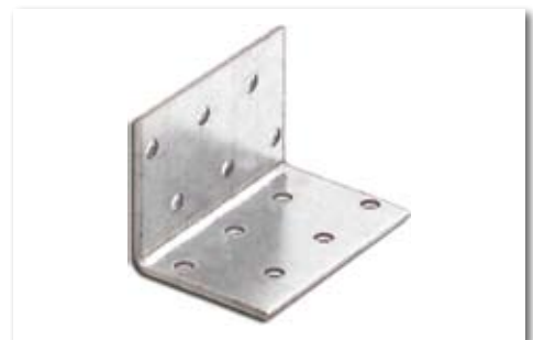
Equerre de connexion à ailes symétriques En acier galvanisé Trous à clouer Ø 5 mm
