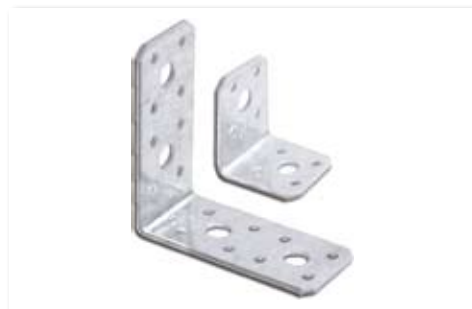
Equerre lisse à ailes symétriques En acier galvanisé Trous à clouer Ø 5 mm et trous à sceller Ø 11 mm
